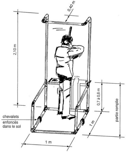
Poste de tir en tubes P.V.C. de couleur, diam. 50 mm Tubes droits + coudes emboîtables.
